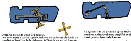
Système de vis de visée Gribeauval - Le canon repose sur un support et la vis de visée est abaissée ou montée en fonction de la distance. A zéro, la vis est mi-hauteur
